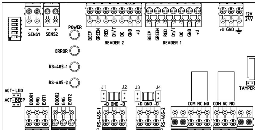
Рисунок 5.2 - Плата модуля внешних подключений STR-1AP
