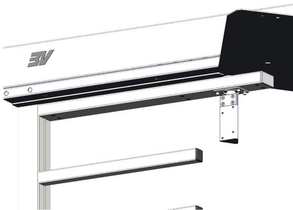
Рисунок 9.15 - Турникет с правильным положением верхнего подшипникового узла
