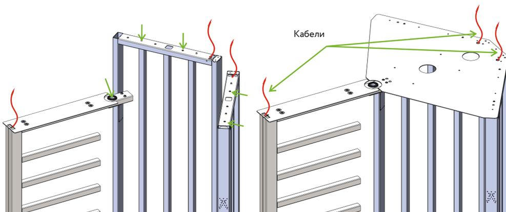
Рисунок 9.8 - Турникет с установленной крышей зоны прохода
