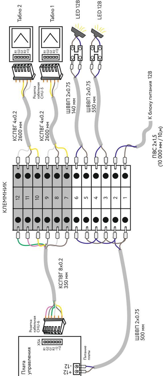
Рисунок 10.1 - Схема соединения с клеммником в корпусе механизма 3V Model X/Xi
