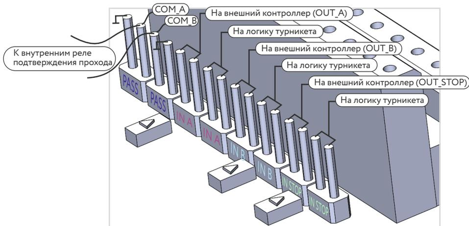
Рисунок 4.3 – Логическая схема использования джамперов пульта
