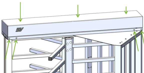
Рисунок 9.24 - Турникет с надетой крышкой корпуса механизма
