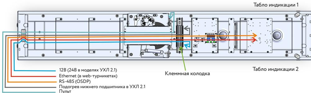
Рисунок 9.23 - Схема подключения турникета 3V Model X / Xi
