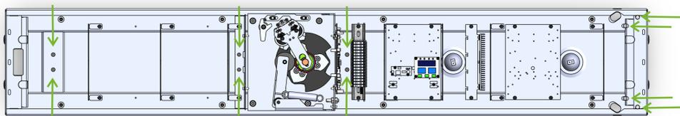
Рисунок 9.10 - Отверстия для крепления корпуса механизма
