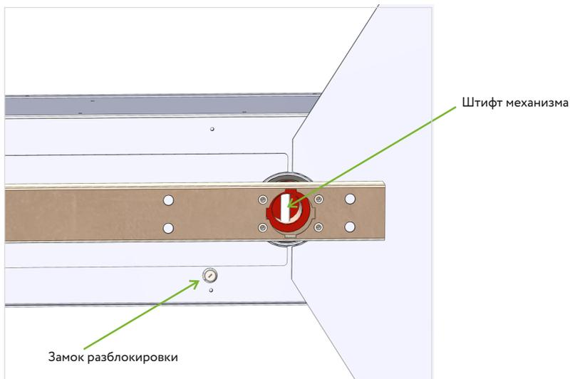
Рисунок 9.12 - Место установки верхнего подшипникового узла (вид снизу)
