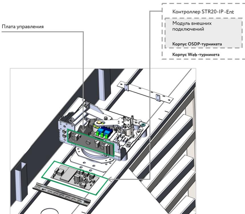
Рисунок 2.2 – Расположение элементов системы в корпусе турникета 3V
