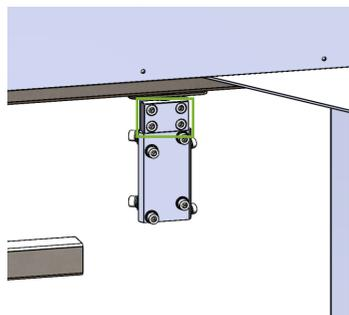
Рисунок 9.16 - Установленная призма верхнего подшипникового узла
