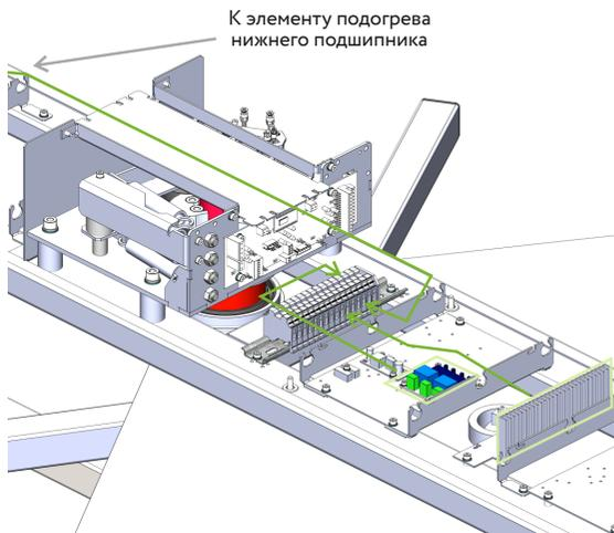
Рисунок 10.3 - Элементы подогрева в корпусе механизма
